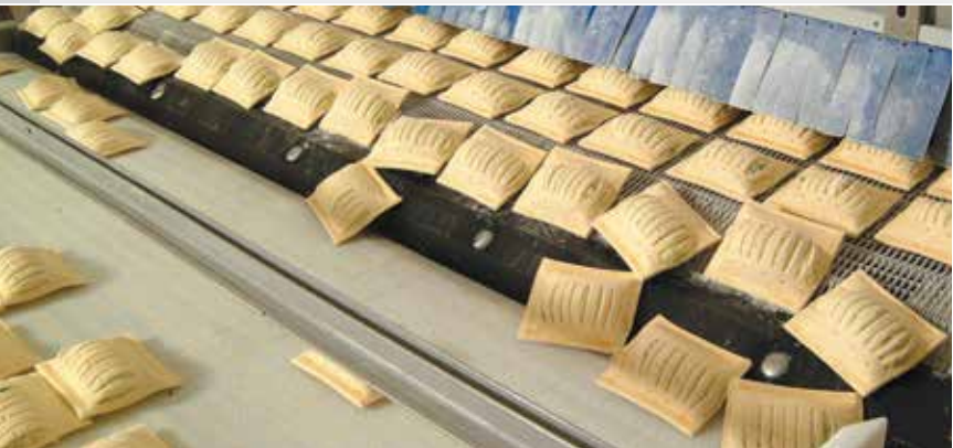
Сетки «ай-линк» могут использоваться в туннелях для заморозки Bakkersland, Hoogeveen, Голландия.
