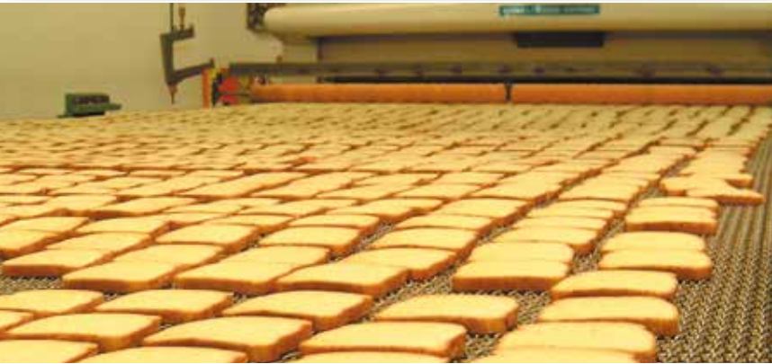
Подовая сетка в печи в Bolleje, Almelo, Голландия.
